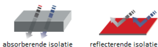
Figuur 1: verschil absorberend en reflecterend isolatiemateriaal
